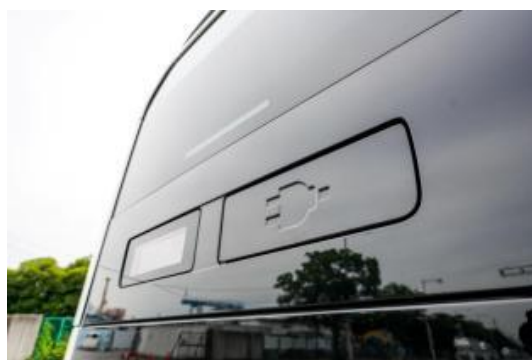
災害時には電源としての活用も可能な外部給電システムのキャップ
